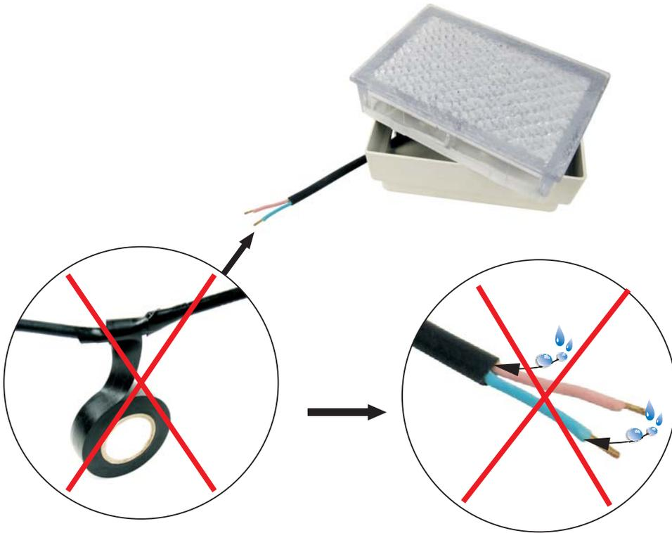
Das Leuchtengehäuse ist wassergeschützt. Wenn das Anschlusskabel nicht gut gegen Feuchtigkeit geschützt ist, so könnte der Fall passieren: Durch Erwärmung der Leuchte wird die Luft aus Kabel ausgepumpt: nach Abkühlung der Leuchte wird die Feuchtigkeit über Kabel eingesaugt, so dass ein Kurzschluss entstehen könnte.
